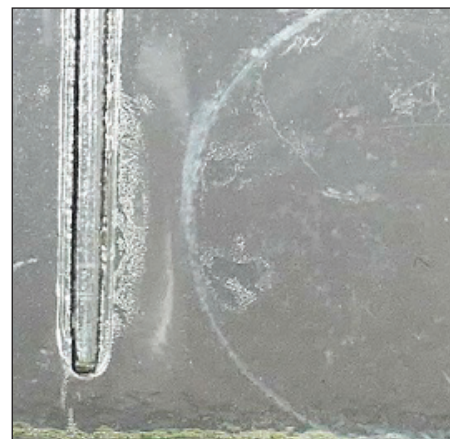
Fig. 10. Nedbrytningsprodukter från plastens mjukgörare i form av bubbelbildning.
